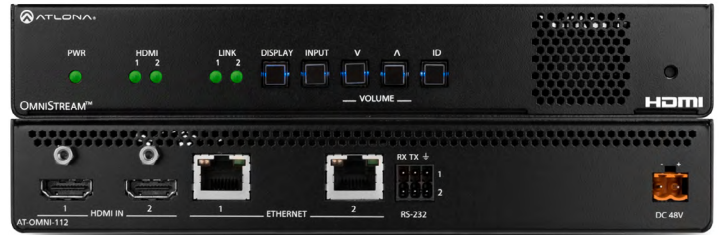
AT-OMNI-112 two-channel AV encoder
